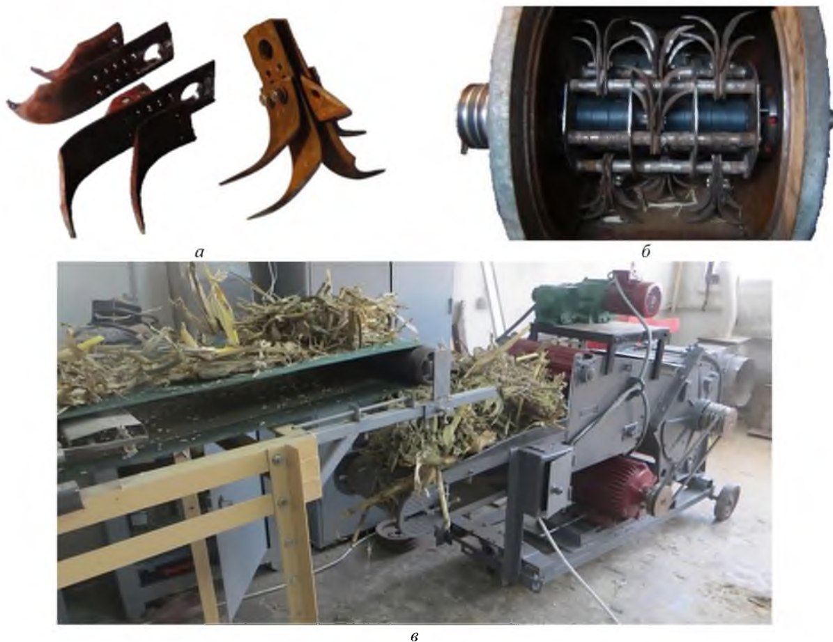
Рис. 1. Конструктивные особенности нового измельчителя грубых и стебельчатых кормов а – комбинированный нож; б – рабочий орган измельчителя; в – измельчитель
